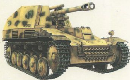
Sd.Kfz. 124 "Besene" - 105 мм самоходная гаубица. Германия, 1943г.
